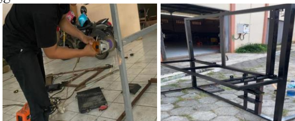
Gambar 9. Pengerindaan dan pengecatan
