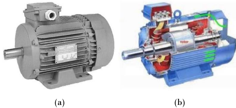
Gambar 3. Motor Induksi 3 Fasa (a) bentuk fisik, (b) komponen pembangun[9]
