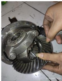
Gambar 7. Backlash roda gigi ring gear dengan drive pinion gear
