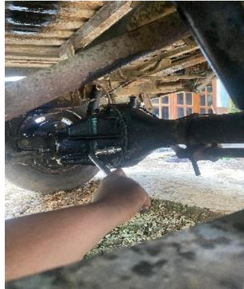
Gambar 4. Pelepasan Baut pada Rumah Gardan
