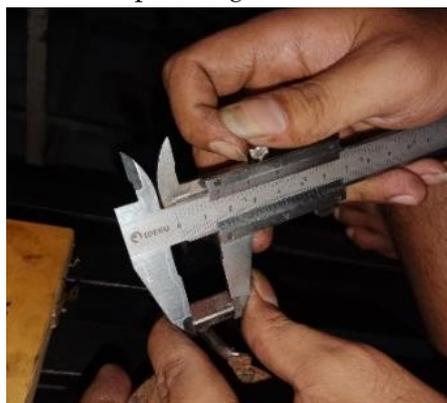
Gambar 9. Pengukuran panjang sikat.
