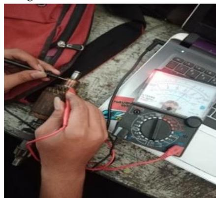
**Gambar 3. Pemeriksaan hubungan di komutator.**
