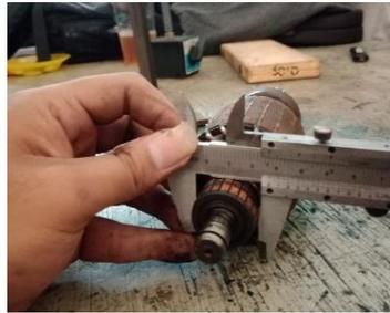
Gambar 5. Pengukuran diameter komutator.
