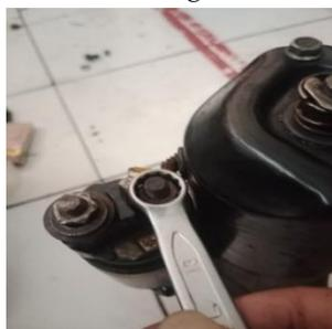
Gambar 1. Pelepasan kabel penghubung terminal C dengan *Field Coil*.
