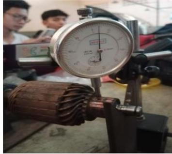
Gambar 4. Pemeriksaan *runout* komutator.
