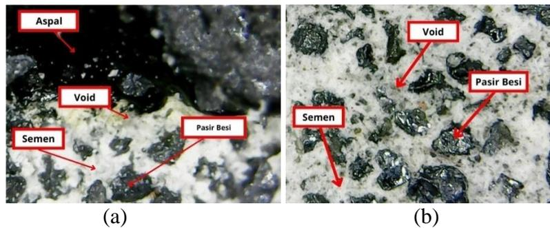
Gambar 2. Foto mikro mortar (a) Lapisan aspal dan (b) Standar
