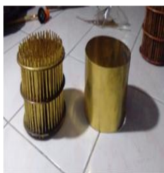
Gambar 2. Desain isi Catalys Tinggi 95 mm, Tebal dudukan 1,5 mm dan Tebal pipa 0,05 mm
