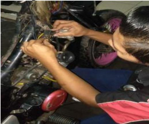
**Gambar 12.** Menyambung Kabel Modul Hitam
