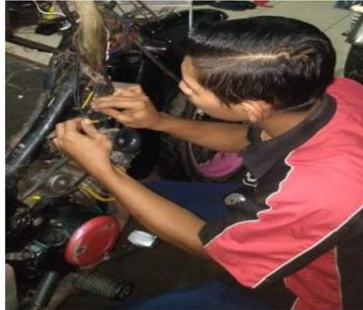
**Gambar 13.** Menyambung Kabel Modul Merah
