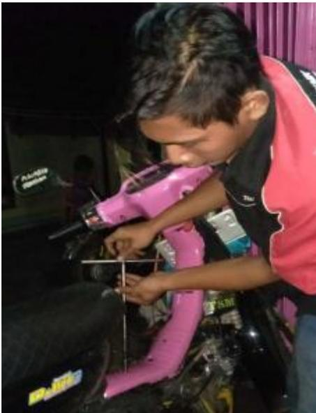
**Gambar 18.** Memasang Body Tengah Sepeda Motor
