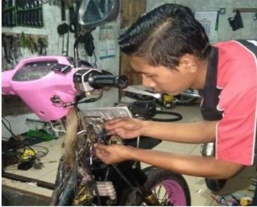
**Gambar 10.** Menyambung Kabel Modul Merah
