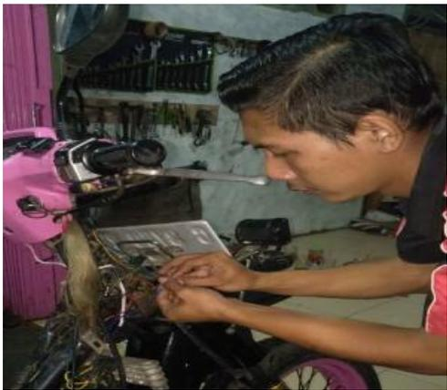
**Gambar 11.** Menyambung Kabel Modul Biru
