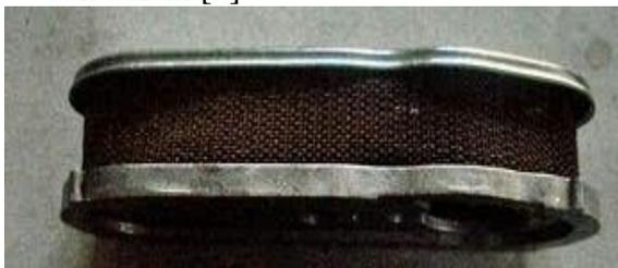
Gambar 2.3 Filter Udara
