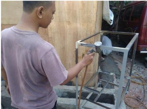
Gambar 17. Pengecatan dasar
