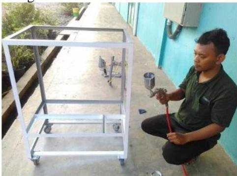
Gambar 18. Pengecatan Warna Dasar
