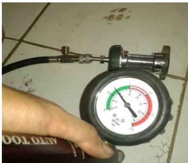
**Gambar 22** : pemeriksaan kebocoran tutup radiator
