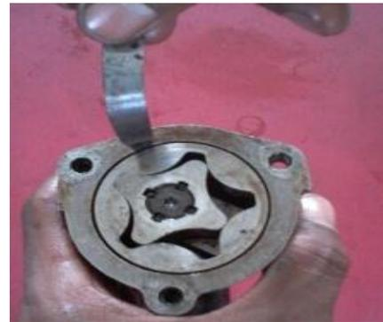
Gambar 3.7 Mengukur celah rotor
