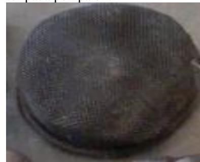
Gambar 3.8 Filter pompa oli
