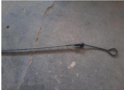
Gambar 2.10 Alat pengukur volume minyak pelumas (Dipstik)
