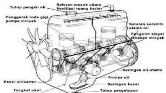
Gambar 2.2 Sistem Pelumasan Basah
