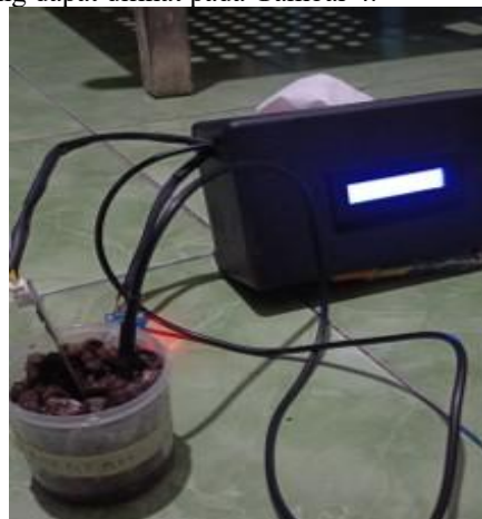
Gambar 4. Implementasi Alat Pendeteksi pada Media Pupuk Kohe Kambing
