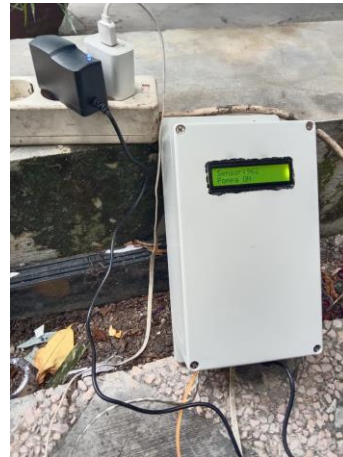
Gambar 7. tampilan LCD menampilkan nilai kelembapan
