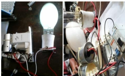
Gambar 4.16. Pengujian ignitor hanya dapat menyalakan lampu mercury sedangkan lampu sodium tidak dapat menyala. ( sumber pribadi )
