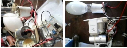
Gambar 4.14. Pengujian Ignitor rusak tanpa keluar arus listrik kelampu sehingga kedua jenis lampu tidak dapat menyala. ( sumber pribadi )
