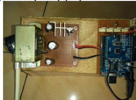
Gambar.4.6 Pemasangan catu daya dan papan pusat soket Sumber : Pribadi
