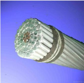
Kabel ACSR merupakan kawat penghantar yang terdiri dari aluminium berinti kawat baja. Kabel ini digunakan untuk saluran-saluran transmisi tegangan tinggi, dimana jarak antara menara/tiang berjauhan, mencapai ratusan meter, maka dibutuhkan kuat tarik yang lebih tinggi, untuk itu digunakan kawat penghantar ACSR.
