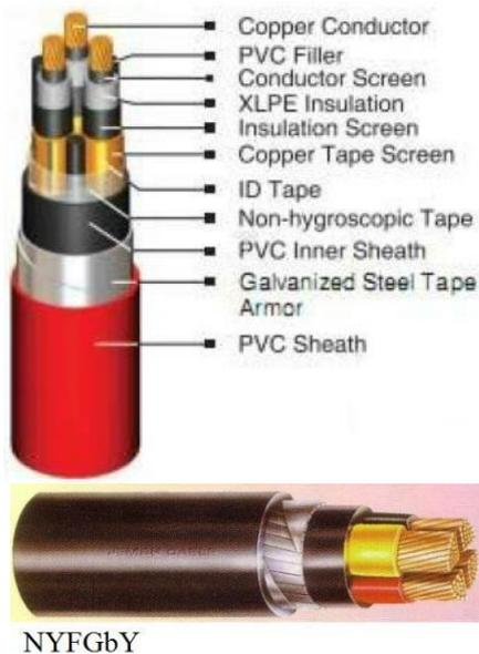
Kabel ini dirancang khusus untuk instalasi tetap dalam tanah yang ditanam langsung tanpa memerlukan perlindungan tambahan (kecuali harus menyeberang jalan). Pada kondisi normal ke dalaman pemasangan di bawah tanah adalah 0,8 meter.
