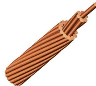
Kabel ini dipilin/stranded, disatukan. Ukuran / tegangan mak = 6 – 500 mm<sup>2</sup> / 500 V Pemakaian = saluran di atas tanah dan penghantar pentanahan.
