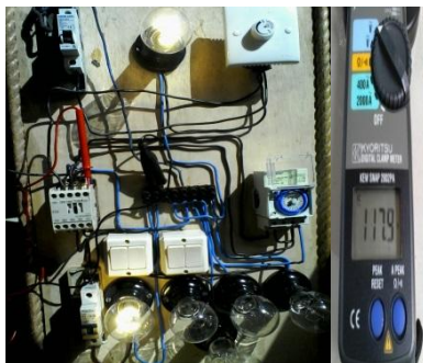
Gambar 4.12. Hasil pengujian Kontaktor pada tegangan 220 Volt, Kontaktor bekerja sangat normal dan tidak bunyi sama sekali lampu indikator menyala terang.
