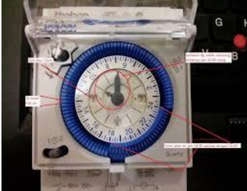
Gambar 2.4. Bentuk fisik dari timmerswitch
