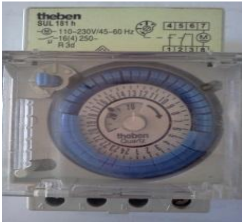
Gambar 4.16. Bentuk fisik timmerswitch.
