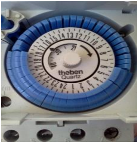
Gambar 4. 17. Timmerswitch telah disetel kisi kisinya, jam 6 pagi sampai jam 6 sore mati, jam 6 malam sampai jam 6 pagi menyala. Jam pada timmerswitch menunjukkan pukul 16.30.
