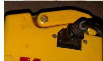
Gambar 4.12 Output Genset dan Input Baterai ( Sumber: Pribadi )
