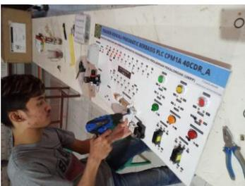
Di tahap selanjutnya adalah tahap pemasangan komponen pada Trainer Kendali Pneumatic berbasis PLC CPM1A 40CDR\_A. Pada tahap ini komponen komponen yang di pasang yaitu Mcb 1 fasa. PLC CPM1A 40 CDR\_A. Lampu pilot. Push botton. Air suply unit. Selenoid valve. Silinder acting pneumatik. Limit swit. dan banana pint untuk megabungkan antara kompen satu ke komponen lain.
