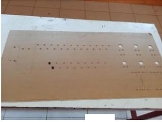
Pada Gambar diatas adalah gambar proses pemotongan triplek melamin putih dan akrelit bening ukuran 3 mm. Media triplek dan akrelit ini akan di jadikan papan Trainer Pneumatic yang akan di buat.
