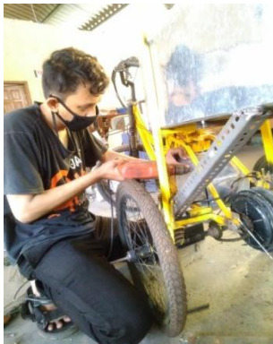
Gambar 3.6 pemasangan plat seng penutup box baterai
