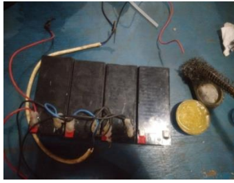
Gambar 3.14 aki dirangkai seri 36V 7.2A
