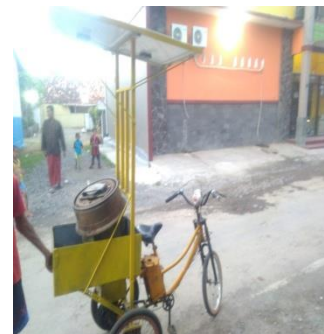
Gambar 4.1 pengujian berat beban 100 Kg
