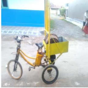
Gambar 4.2 pengujian berat beban 50 Kg
