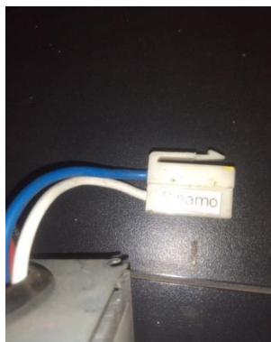
Gambar 3.16 kabel controller ke dinamo BLDC (sumber : pribadi )
