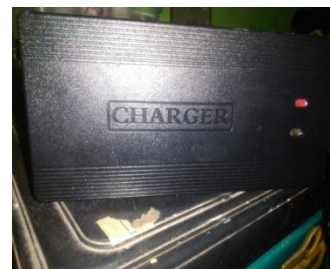
Gambar 4.4 pengujian pengisian baterai penuh ditandai dengan lampu indikator menyala merah-hijau
