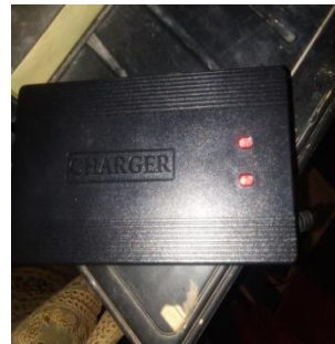
Gambar 4.3 pengisian baterai ditandai dengan lampu indikator menyala merah-merah
