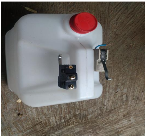
Gambar 3.15 Limit switch sebagai pengontrol air
