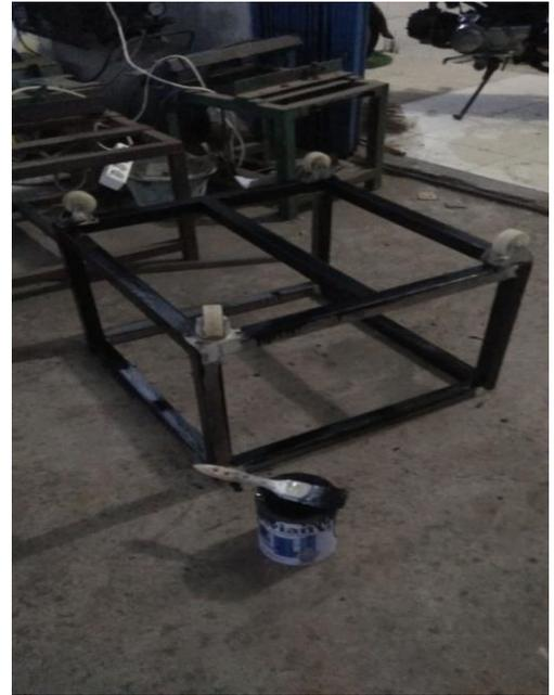
**Gambar 3.7** Rangka kotak (*box*) yang sudah dicat.
