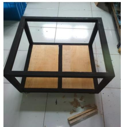
**Gambar 3.8** Rangka kotak (*box*) yang sudah dipasang triplek.
