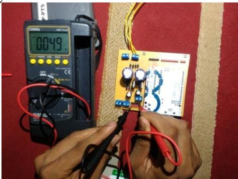
Gambar 4.9 Pengukuran tegangan pin 5V
