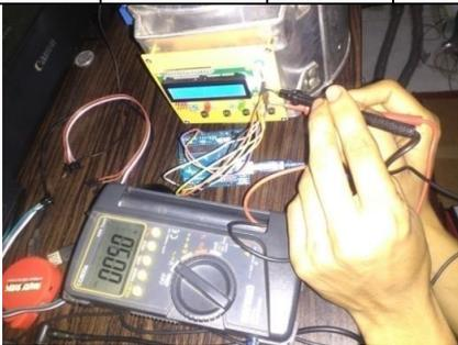
Gambar 4.11 pengujian tegangan LCD
