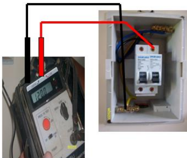
Gambar 13. Simulasi pengukuran isolasi penghantar Fase – proteksi
