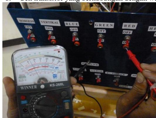
Gambar 20. Pengujian Warna (RGB) Bagian R (Red)
