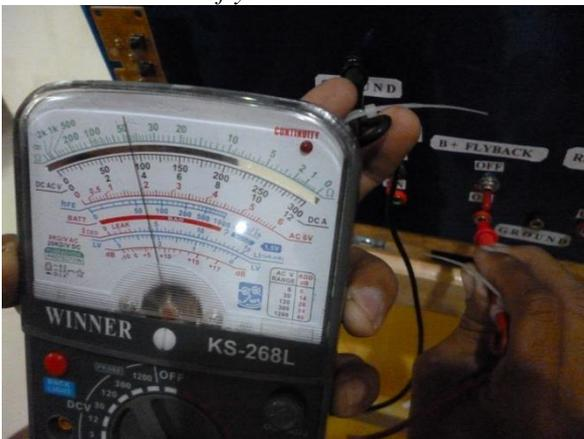
Gambar 25. Pengujian B+ Flyback
