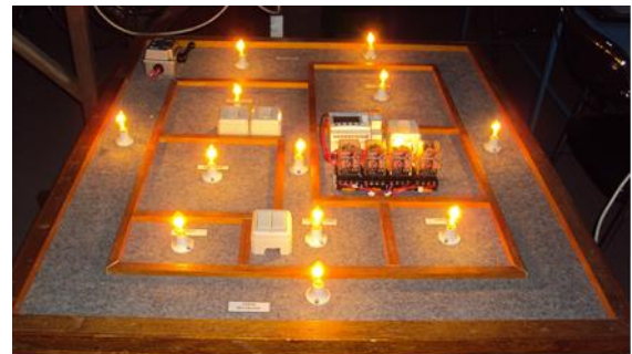
Gambar 13 Hasil Pengujian Simulasi Miniatur Instalasi Penerangan Rumah Cerdas Sederhana tipe 36
