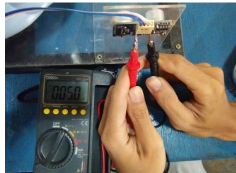
Gambar.4.10 Pengukuran tegangan masukan sensor ultrasonik Sumber: Pribadi
