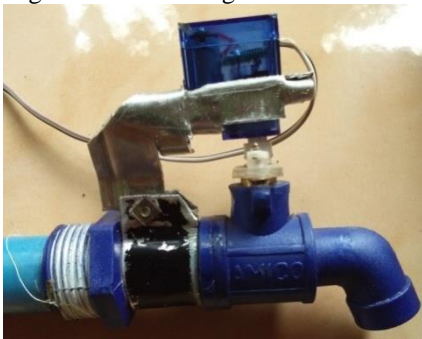
Gambar.4.4 Penghubung motor servo dengan kran Sumber : Pribadi
