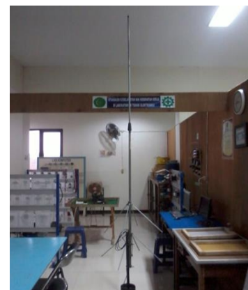
Gambar 20 Bentuk Antena Telek 2x 5/8 Lamda
