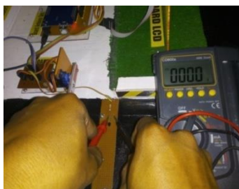
Gambar 4.2 Tegangan sensor infrared tanpa penghalang
