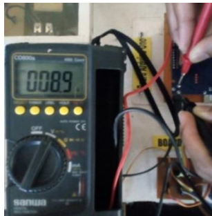
Gambar 4.1 Tegangan input arduino uno atmega328
